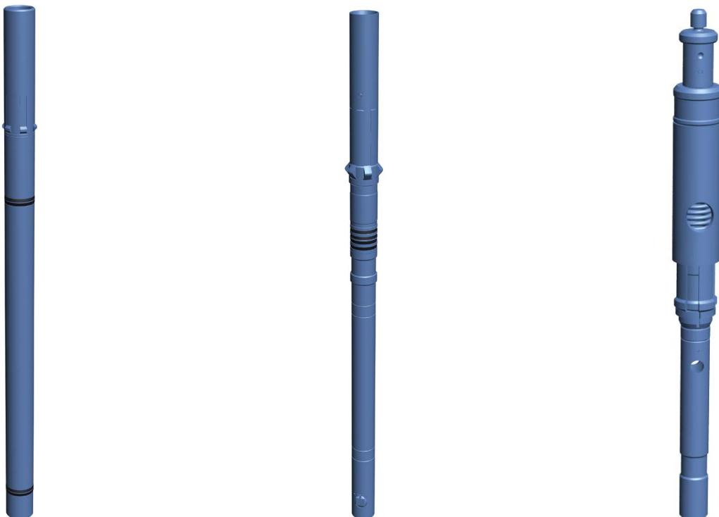
Принадлежностью клапана-отсекателя является **разделительная втулка с замком** для установки ее в клапан-отсекатель для его принудительного открытия без подачи давления управления в процессе работы с оборудованием, установленным ниже клапана-отсекателя.
